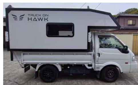
実はこのTRUCK ON HAWK、トヨタ社のタウンエースやマツダ社のボンゴなど荷台のサイズ・軸重等が合えばどのトラックでもベース車として使用することができます。
